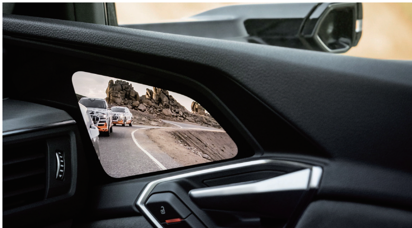
→ Image 42 삼성디스플레이의 7인치 OLED가 사용된 '버추얼 익스테리어 미러'
