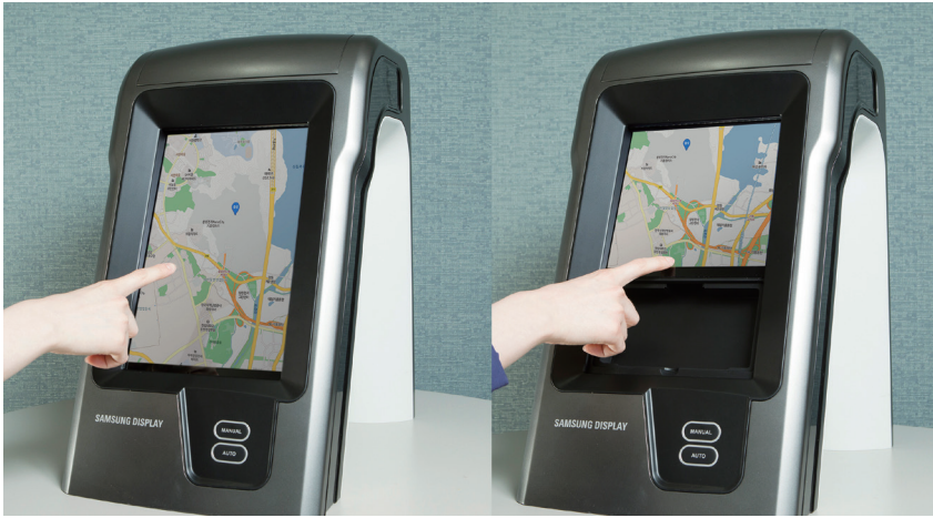
→ Image 39 최소 9인치, 최대 14인치까지 크기를 조절할 수 있는 삼성디스플레이의 플러블 CID 디스플레이
